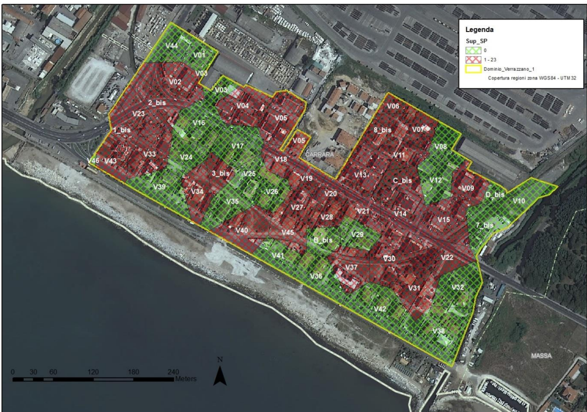
Figura 2 - Contaminazione Suolo profondo – Poligoni di Thiessen (in rosso i sondaggi con superamenti delle CSC; in verde i sondaggi senza superamenti delle CSC).
