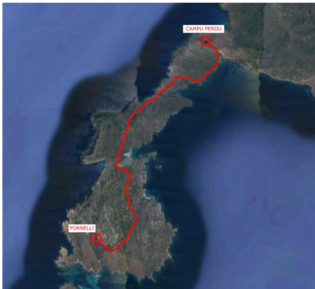
Figura 1_Ipotesi di individuazione tracciato condotta interrata
